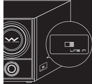
2 將3.5mm音源線插入主機input中
